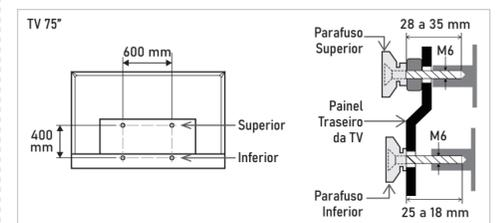
**ATENÇÃO:** Não aperte demais os parafusos, pois isso pode causar danos à TV e anular a garantia. NOTA: Se os pedestais estiverem fixados, remova-os antes de instalar em um suporte de parede. Para removê-los, siga as instruções do item 4 "Instalação dos Pedestais" ao contrário (do passo 3 ao 2). Não se esqueça de colocar a TV sobre uma mesa (coberta com um pano macio) com a tela virada para baixo, antes de iniciar a remoção.
